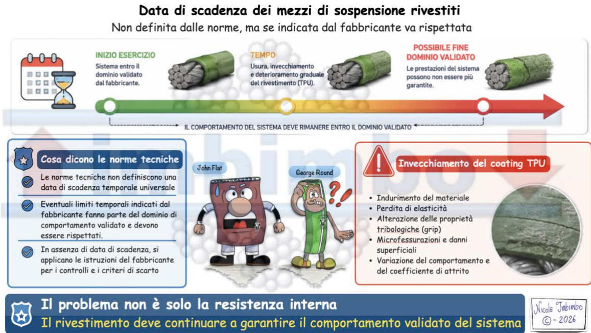
Figura 3- La vita utile di un mezzo di sospensione rivestito è legata al mantenimento del comportamento validato del sistema. Qualora il fabbricante dichiari una durata massima di impiego, tale limite deve essere considerato parte integrante delle condizioni di validazione del prodotto e rispettato indipendentemente dallo stato apparente delle cordicelle interne.
